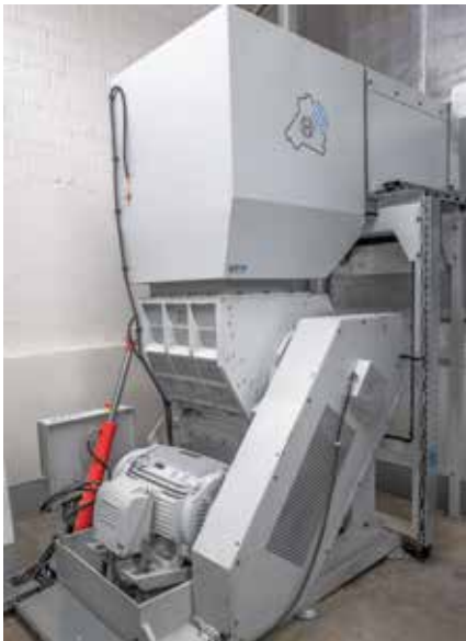
Anfahrschrott und Angüsse, die nicht direkt in der Produktion zerkleinert und zurückgeführt werden, gelangen sortenrein vorsortiert zu Großschneidmühlen in den Keller. Die Technik der vier Mühlen ist leicht zugänglich. Sie arbeiten so leise, dass sie die Beschicker von zu großem Lärm entlasten.
