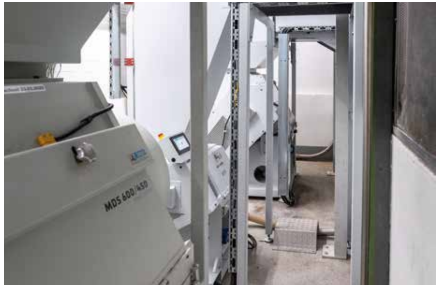
Anfahrschrott und Angüsse, die nicht direkt in der Produktion zerkleinert und zurückgeführt werden, gelangen sortenrein vorsortiert zu Großschneidmühlen in den Keller. Die Technik der vier Mühlen ist leicht zugänglich. Sie arbeiten so leise, dass sie die Beschicker von zu großem Lärm entlasten.
