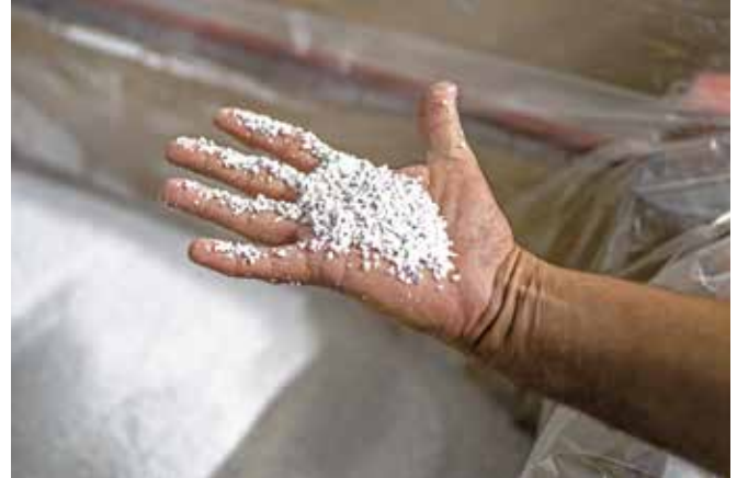
Vor jeder Mühle arbeitet ein Metalldetektor und hinter jeder Mühle ein Metallseparator. Sortenreines und metallfreies Regranulat ist das Ergebnis.
