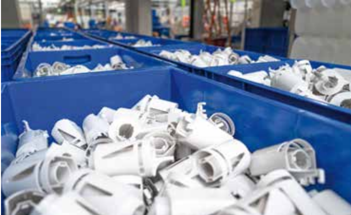
Neben Blasformmaschinen für Spülkästen stellen am größten Geberit-Produktionsstandort Spritzgießmaschinen Zubehör für die Spülkastensysteme her.
