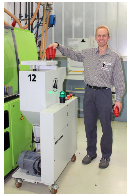
Herr Gehele demonstriert die sichere Vermahlung schwerer Stecker auf einer Beistellmühle des Typs MDS 240/200
